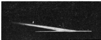
Abb. 5. Geschwindigkeits-Analyse von Elektronenstrahlen aus der Gasentladungskathode durch Einwirkung des Magnetfeldes der Erde.
